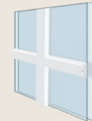
aufgesetzte Sprosse ohne Abstandhalter im Scheibenzwischenraum
