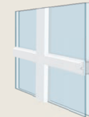
aufgesetzte Sprosse mit Abstandhalter im Scheibenzwischenraum
